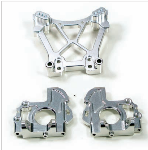
Supporto ammortizzatori e spallette delle cellule in alluminio. Per adattare le cellule alle spalle (originariamente prodotte per il Nemesis), è necessario realizzare delle boccole di adattamento.
