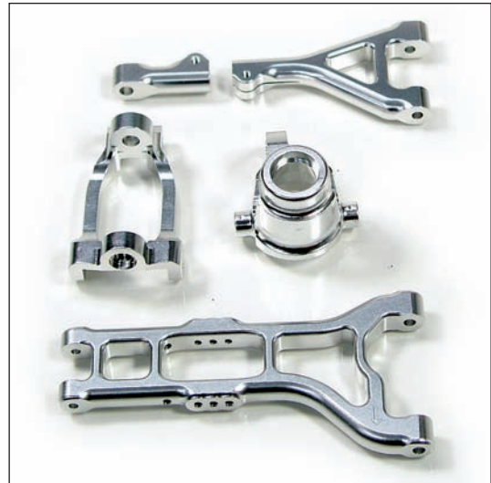
I componenti della sospensione: l'alluminio con cui sono realizzati è anodizzato Silver, non solo per motivi estetici ma soprattutto per migliorarne le caratteristiche meccaniche, aumentandone la durezza superficiale.
