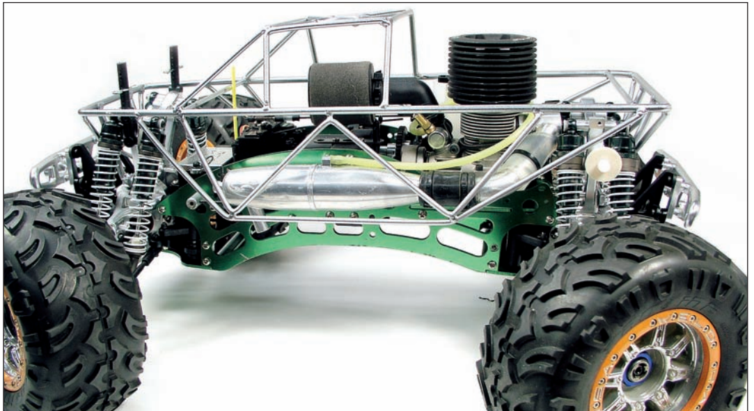
La cage bar è stata adattata, abbassandola in modo che il tetto sia appena più alto della testa del motore e che il tappo del serbatoio sia a filo delle barre posteriori.
